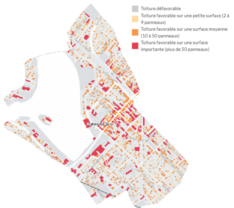
Gisement solaire des toitures
